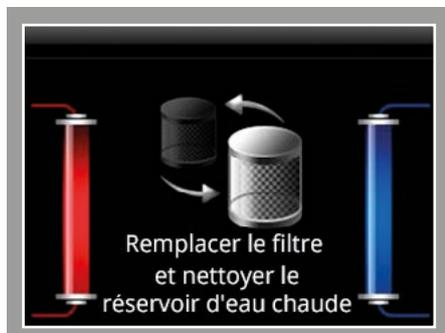
La cartouche filtrante MAXI de BIBO doit être remplacée tous les 6 mois. Lorsque le filtre doit être remplacé, l'affichage du BIBO vous alertera. Ce message apparaîtra lorsque le remplacement est nécessaire :
