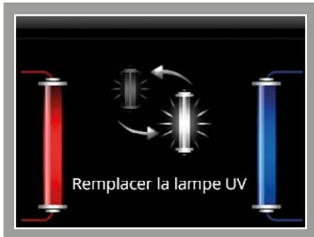
La lampe à filtre UV doit être remplacée tous les 12 mois. Lorsqu'il doit être remplacé, l'écran de BIBO vous avertit. Ce message elle apparaît lorsque le remplacement est nécessaire :
