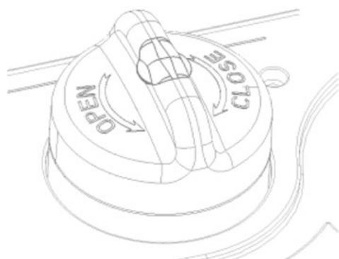
**OUVRIR** – Tournez fermement dans le sens inverse des aiguilles d'une montre pour retirer le filtre usagé.
