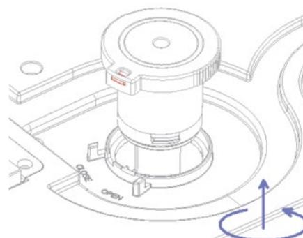
Retirez la lampe UV de remplacement de son emballage, puis insérez-la soigneusement. Ensuite, tournez-la dans le sens des aiguilles d'une montre jusqu'à la position FERMÉ, elle s'enclenche et se verrouillera.
