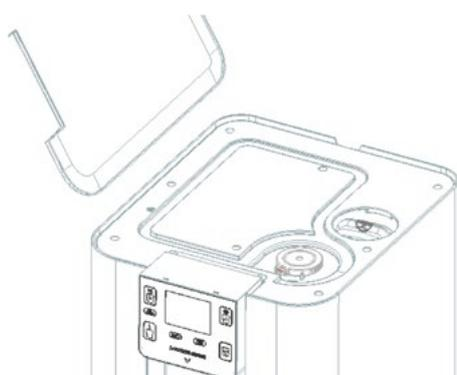
Retirez le couvercle sur le dessus du BIBO en le soulevant simplement. Il est préférable de soulever d'abord le couvercle par l'arrière.
